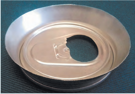
Рис. 4. Макет увеличенного круглого электрода
