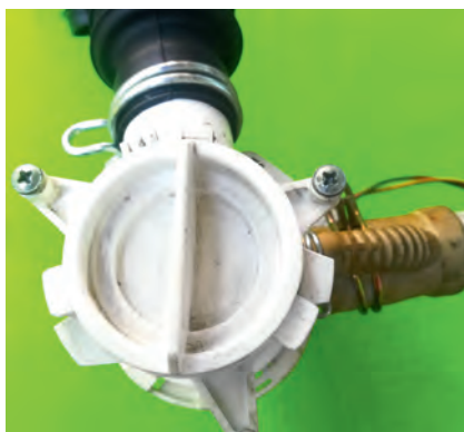
Рис. 2. Насос со стороны крышки фильтра грубой очистки
