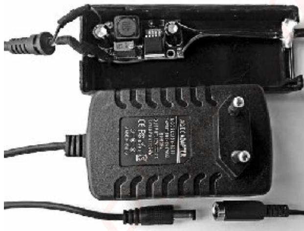
При перегрузке уменьшается яркость свечения индикатора или он начинает мигать. Штекер XW1 с проводом длиной 88 см – принадлежность адаптера. Дополнительно необходимо гнездо XW2 5.5/2.1 для подключения готового покупного модуля DC/DC понижающего регулируемого преобразователя А2 на микросхеме LM2596S, обеспечивающего без радиатора выходной ток 2 А. Выходное напряжение постоянного тока регулируется подстроечным резистором в пределах (1.5-11.4) В при входном напряжении 12 В.
