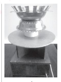
проводом с вилкой подключался не к сети 230 В, а к ручке кастрюли. При работе аэроионизатора в таком эксперименте за один час водородный показатель воды рН уменьшился с 6,1 до 5,9. Измерение выполнялось цифровым рН-метром. При измерении рН-метром нужно дождаться плавного уменьшения показаний на цифровом дисплее, если значение остается в течение 30 с без изменений, это и будет правильный результат.
